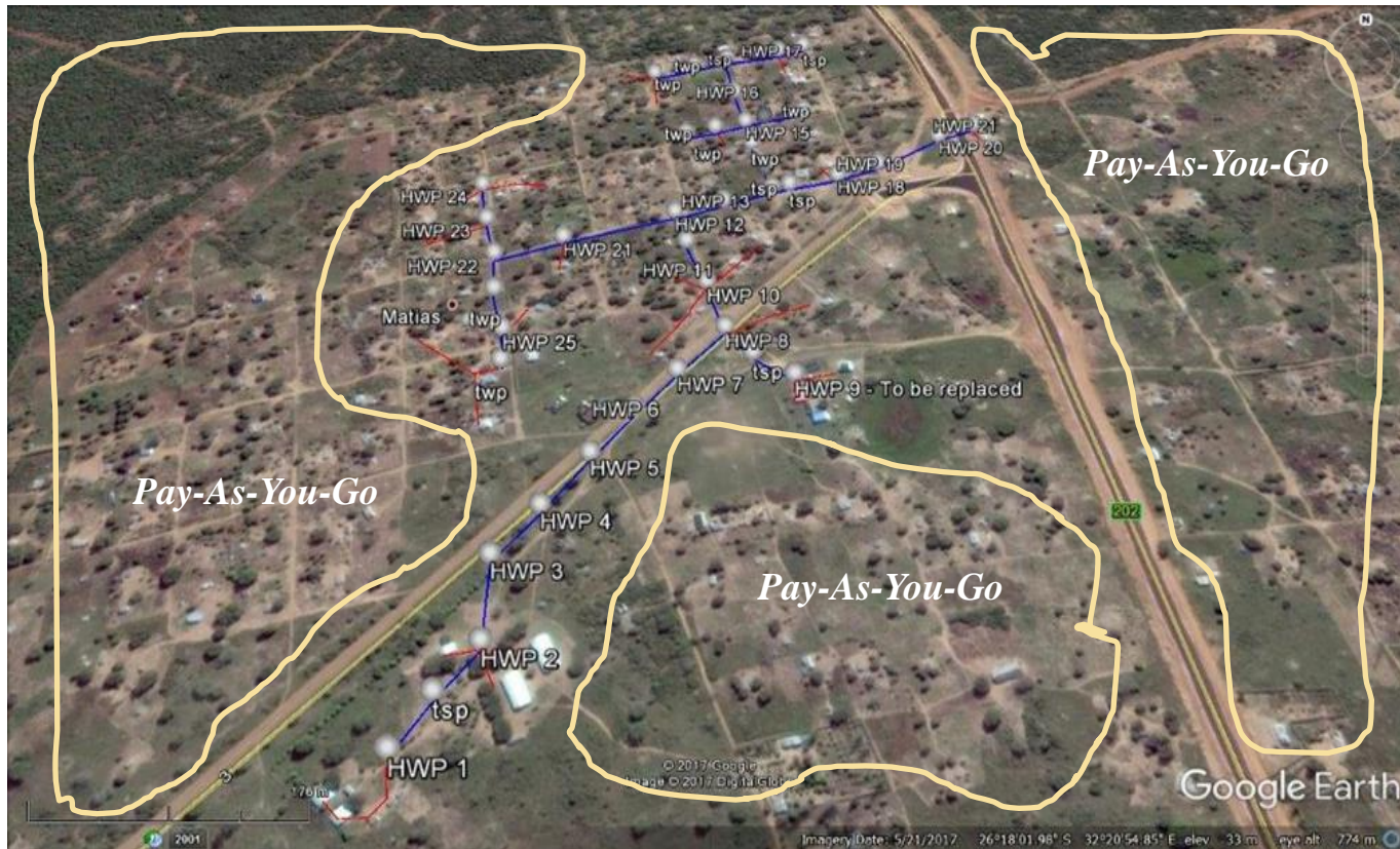
Visão geoespacial e rede de distribuição do Povoado de Porto Henrique. Potencia Instalada 10 kW; 40 ligações.
