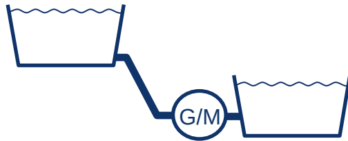
Centrales Hidráulicas de Bombeo
