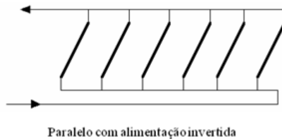
Paralelo com alimentação invertida Figura 2.5 Alimentação invertida; Fonte: Manual Instaladores Solares Térmicos INETI
