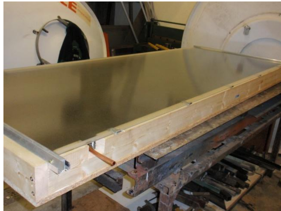
Figura 3.26 Vidro assente na estrutura
