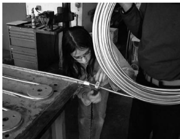
Figura 3.6 Corte dos Tubos, Fonte: Documentação Técnica da Sebasol
