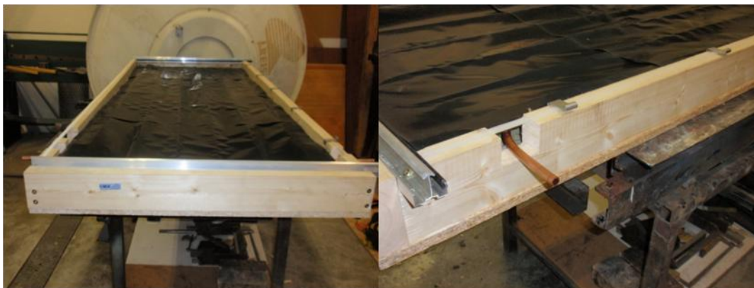
Figura 3.24 Perspectivas da colocação da placa absorsora com pormenor de saída do tubo de cobre
