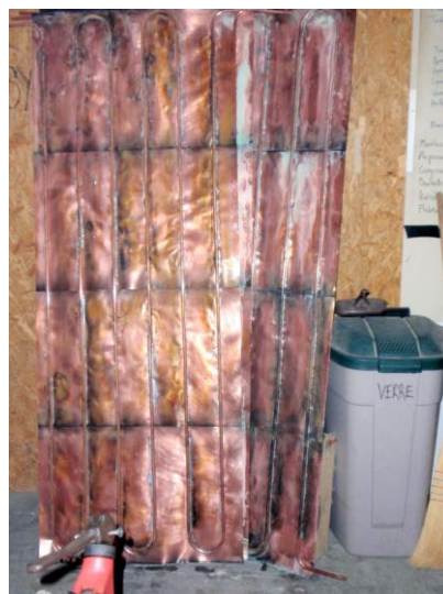
Figura 3.8 Placas e tubos soldados
