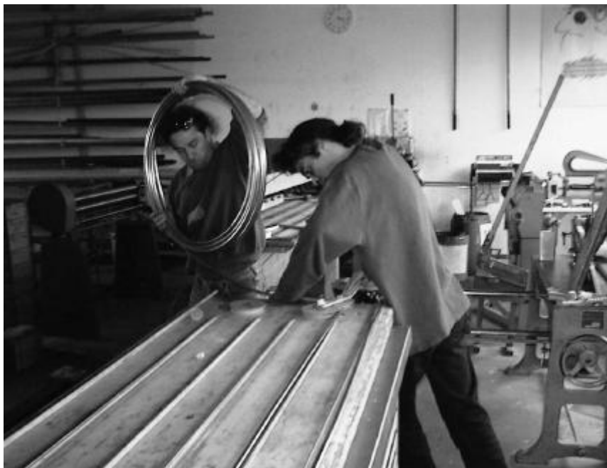
Figura 3.4 Desenrolar e dobrar os tubos por cima da mesa; Fonte: Documentação Técnica da Sebasol
