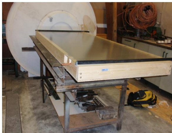
Figura 3.10 Fotografia do colector terminado
