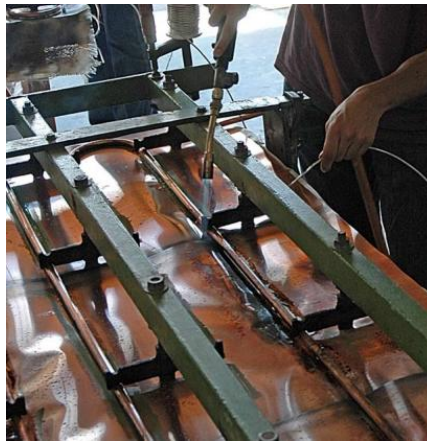
Figura 3.7 Mesa para soldar tubos e placas selectivas.
