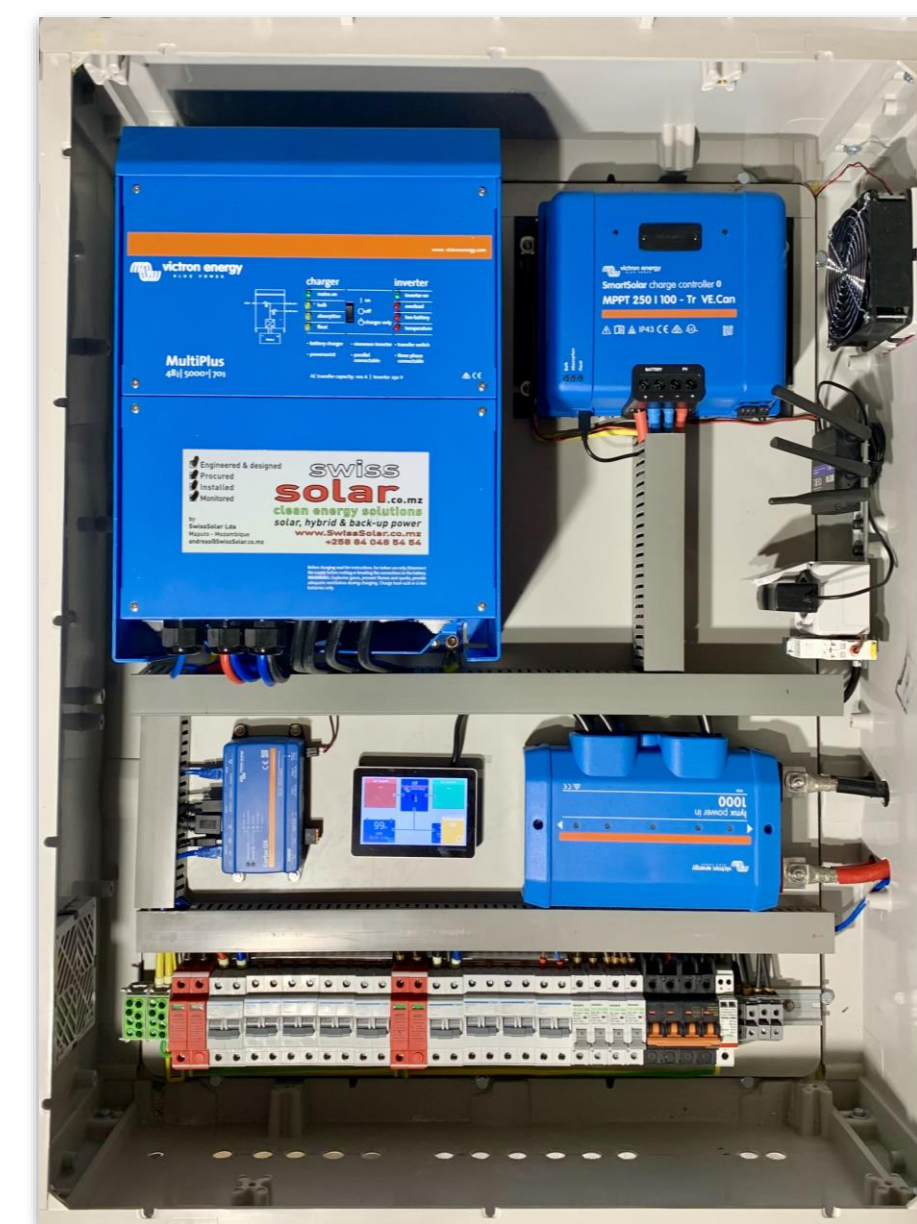
Em cima: solução de armário de fibra de vidro IP 66 para eletrificação rural e aplicações de energia produtiva ao ar livre, disponível nas versões 5kVA - 8kVA - 10kVA, max. 2 MPPTs / 14.4kWp incluindo distribuição elétrica e roteador wifi / GSM
