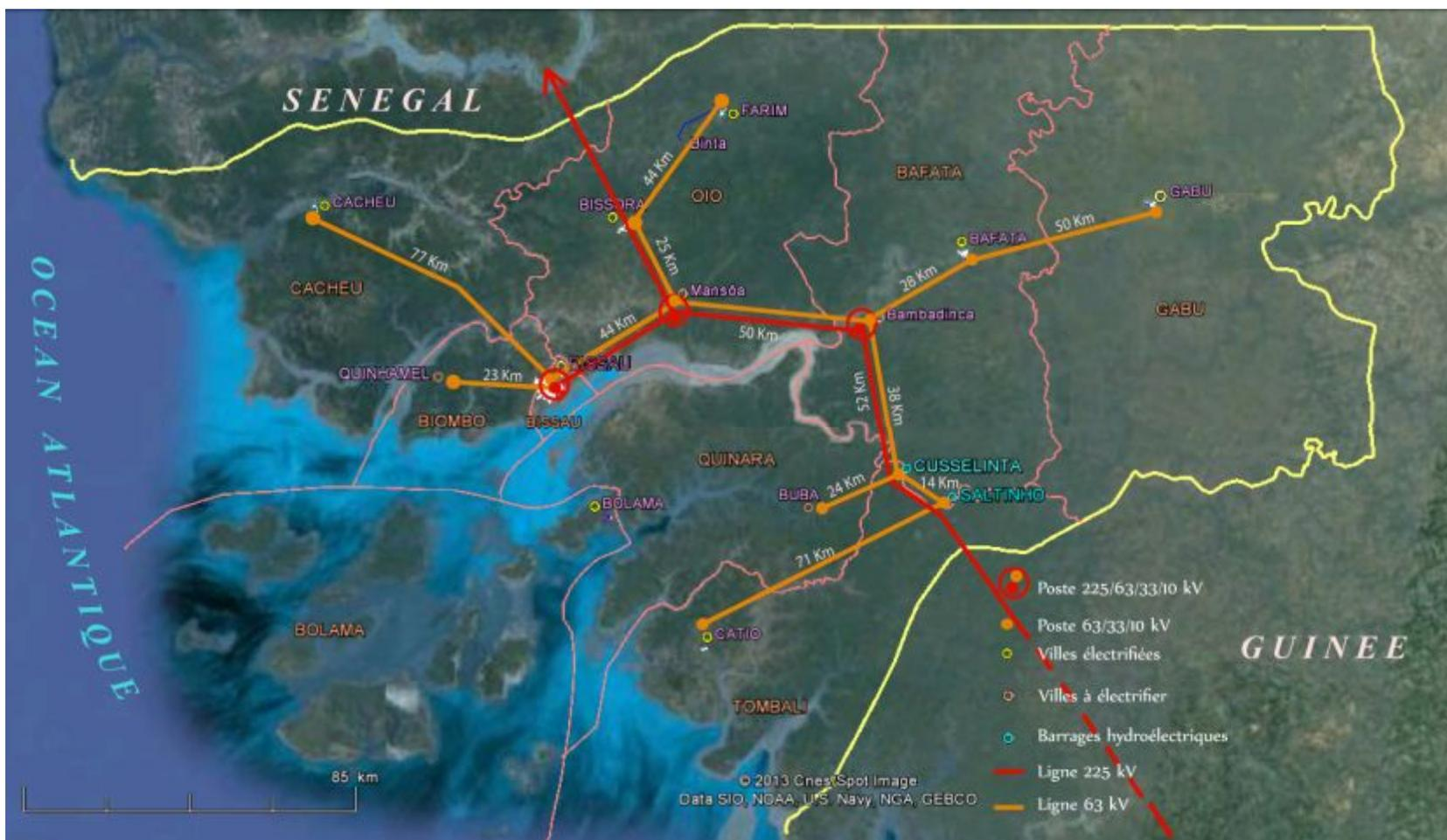
Fig. 3.2 : Ossature cible du réseau de transport 225/63 kV de Guinée Bissau (en 2025) – Option 63 kV.
