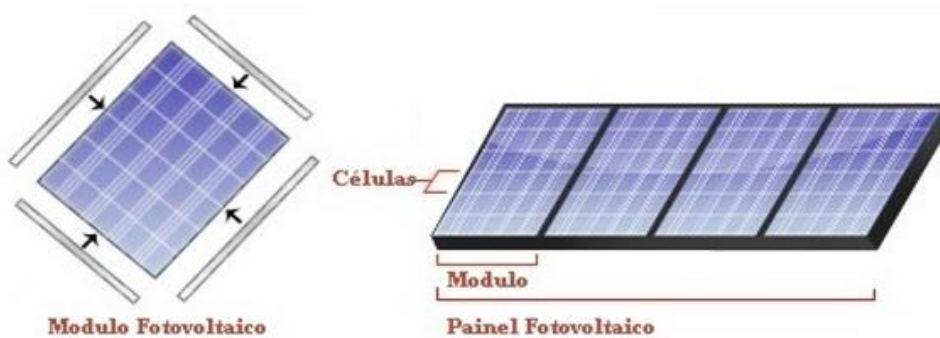
Figura 2.14 - Módulo e Painel Fotovoltaico [24]
